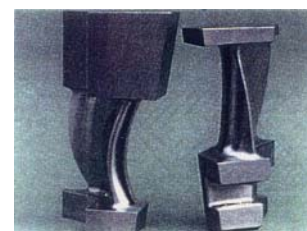
(取替後 3次元流体設計翼)
