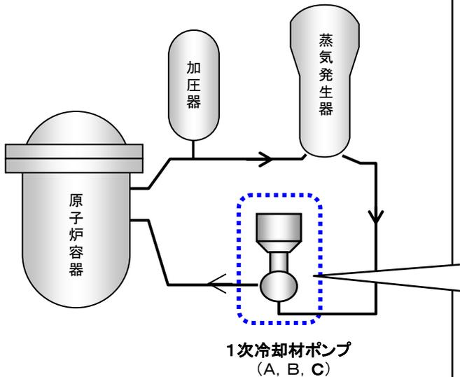
1次冷却材ポンプの概要図
