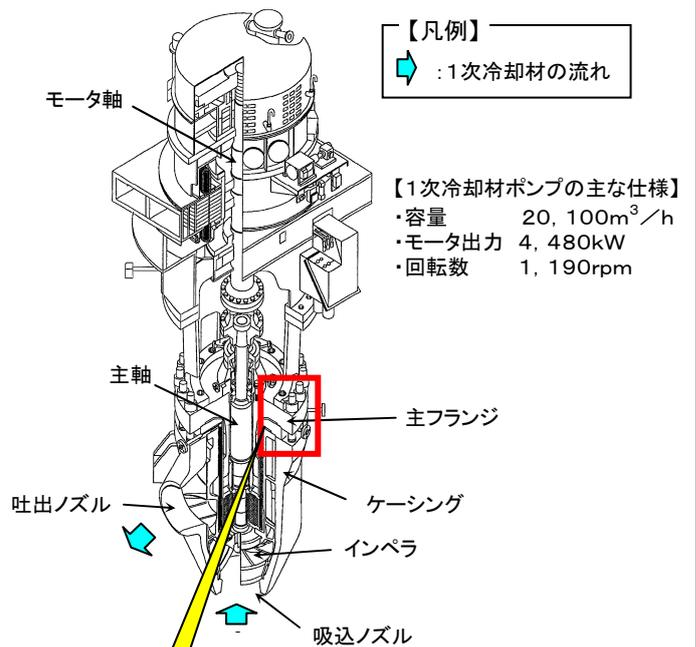
A号機 1次冷却材ポンプの点検概要図
