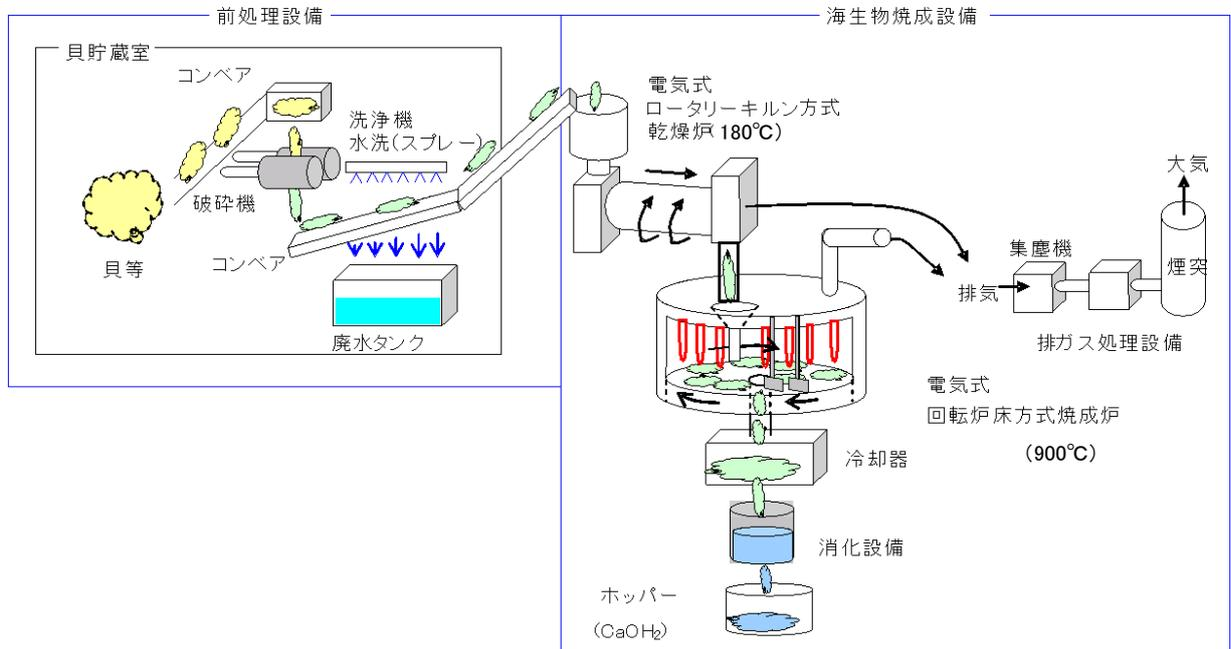
海生物焼成設備：幅約25m×奥行き約10m×高さ約6m
