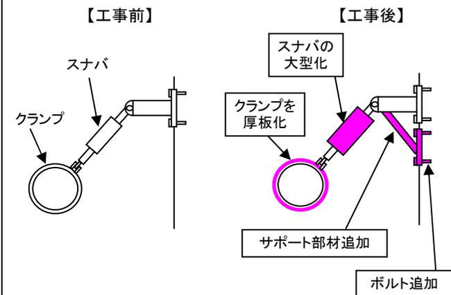
内部スプレイクーラの支持構造物の強化例(イメージ)
