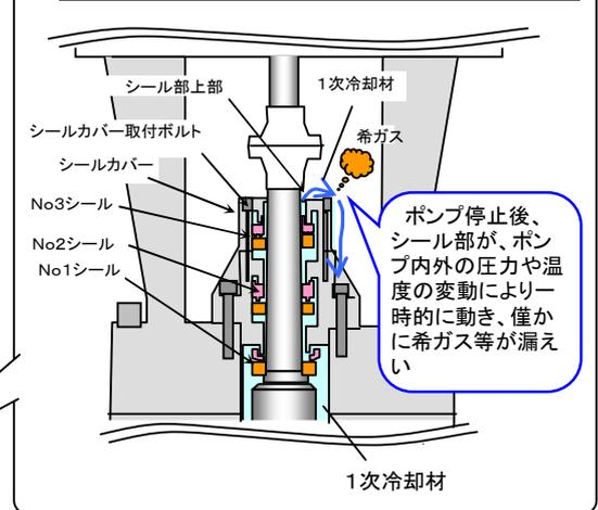
B-1次冷却材ポンプ停止後、シール部が、ポンプ内外の圧力の変動等により一時的に動き、僅かに希ガス等が漏れい
