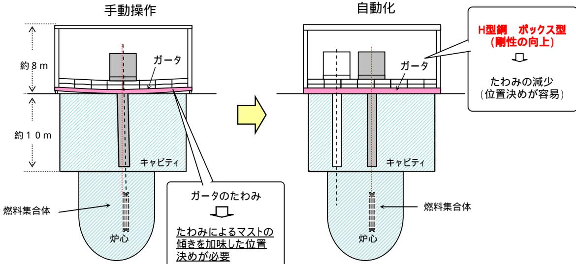
ガータ剛性の向上および操作の自動化により、クレーンの位置決めを容易にする。
