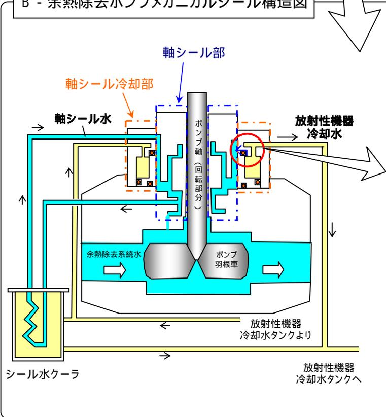
Oリングシール機能低下推定メカニズム
