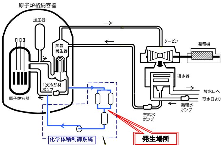
冷却材脱塩塔切替操作
