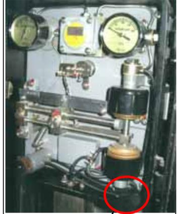
ゴム管にひび割れが発生し、空気が漏れいした。
