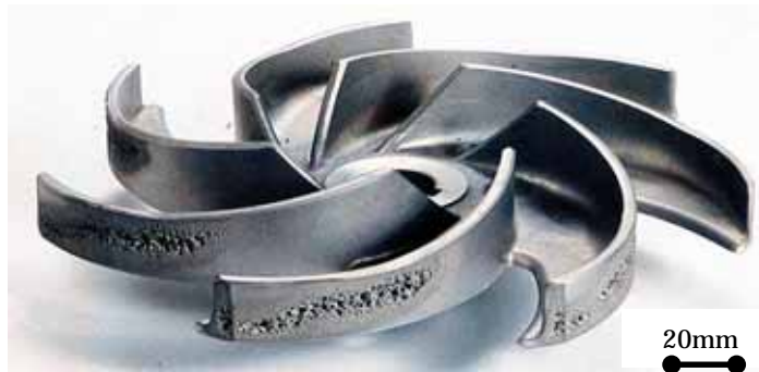
図4 ポンプインペラ（SUS316鋼）のキャビテーション発生例
