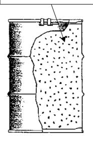
原子力発電所の定期検査時等の工事に伴い発生した低レベル放射性廃棄物で、濃縮廃液等をドラム缶にセメント、アスファルト等を用いて均質・均一に固型化したもの。
