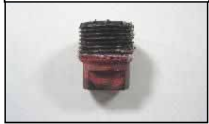
加熱蒸気室ドレン抜き栓の写真
