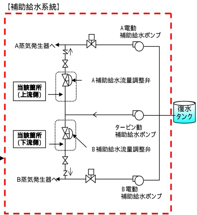
当該箇所は、事故時などプラントが停止し蒸気発生器の水位が低下した場合に使用する系統であり、通常は水が流れない系統である。
