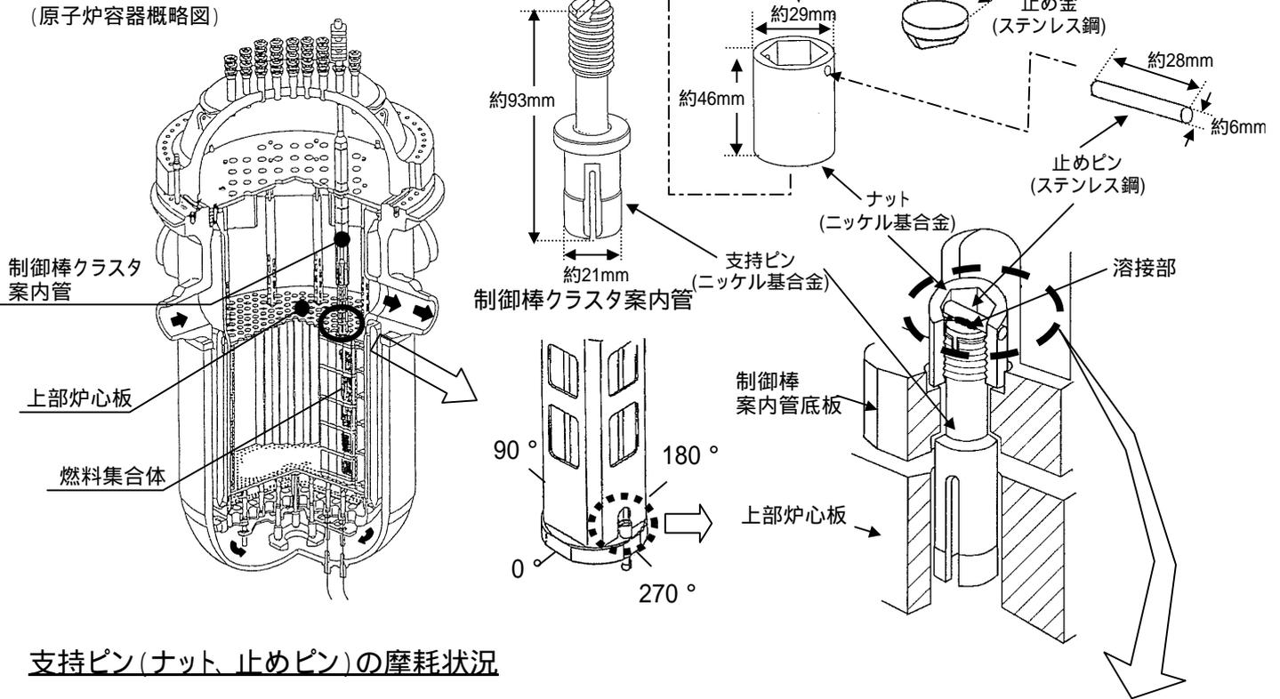
支持ピン(ナット、止めピン)の摩耗状況
