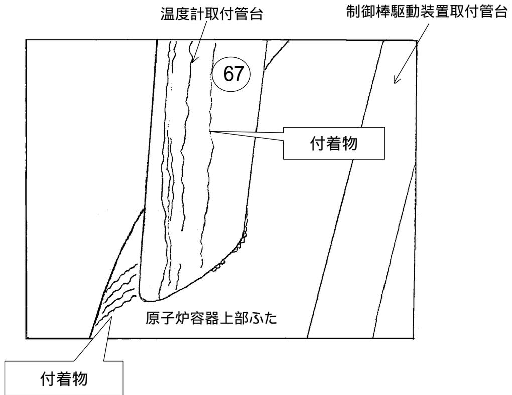
温度計取付管台の構造図
