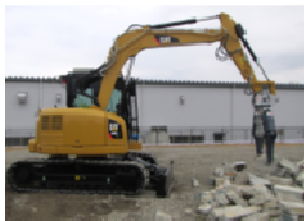
小型・大型無線重機 （屋外の瓦礫等の除去）
