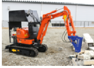
小型・大型無線重機 （屋外の瓦礫等の除去）
