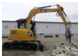
小型・大型無線重機 (屋外の瓦礫等の除去)
