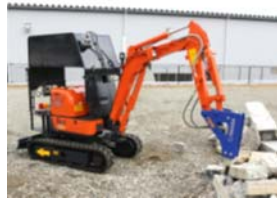
小型・大型無線重機 (屋外の瓦礫等の除去)
