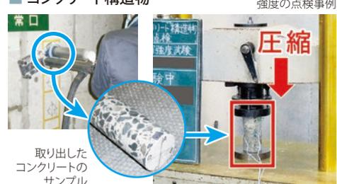
原子炉格納施設等から温度など使用環境が厳しい箇所を中心に、性質の変化状態および強度を確認するために、号機ごとにコンクリートのサンプルを取り出し、問題がないことを確認しました。
