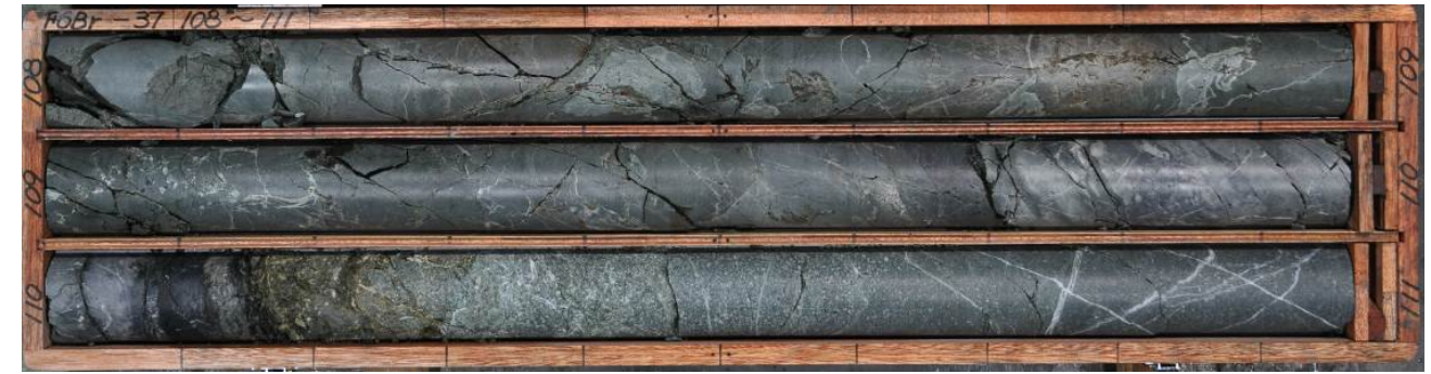
No.37ボーリング(孔口標高:EL.13.46m、掘進方向:49°、掘進角度:60°、掘進長:140m)
