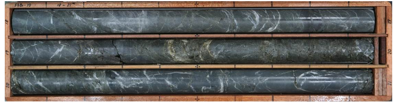
No.10ボーリング(孔口標高:EL.15.38m、掘進方向:93°、掘進角度:70°、掘進長30m)
