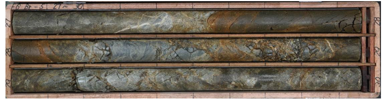
No.5ボーリング (孔口標高: EL.9.40m、掘進方向: 249°、掘進角度: 60°、掘進長: 80m)
