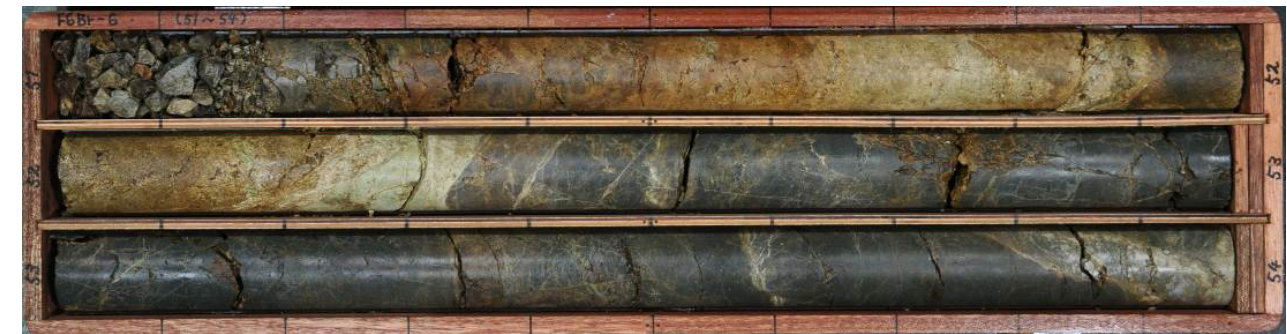
No.6ボーリング(孔口標高:EL.22.12m、掘進方向:229°、掘進角度:75°、掘進長:65m)
