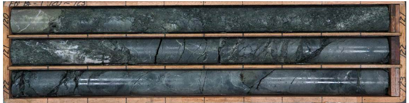
No.1ボーリング(孔口標高:EL.9.76m、掘進方向:49°、掘進角度:70°、掘進長:135m)
