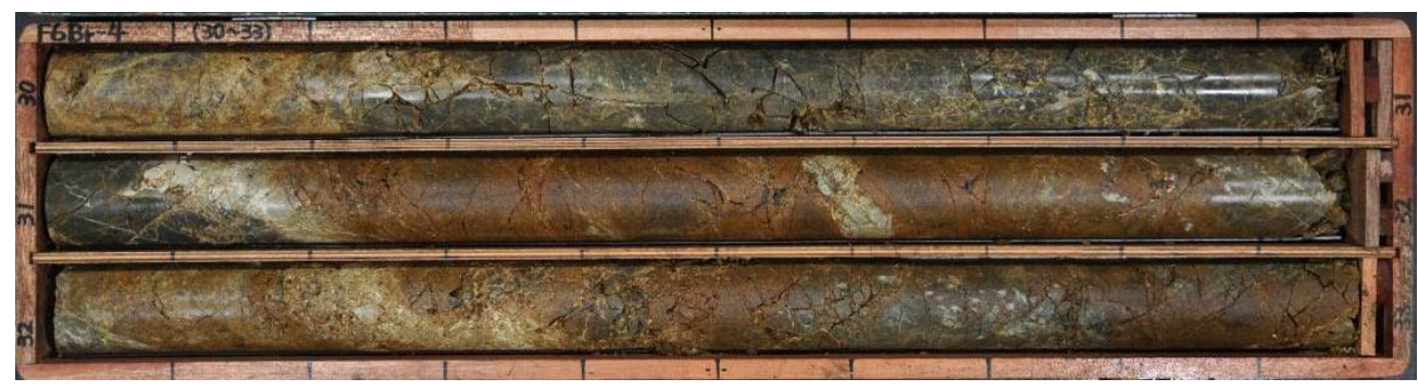
No.4ボーリング(孔口標高:EL.13.5m、掘進方向:49°、掘進角度:75°、掘進長:130m)
