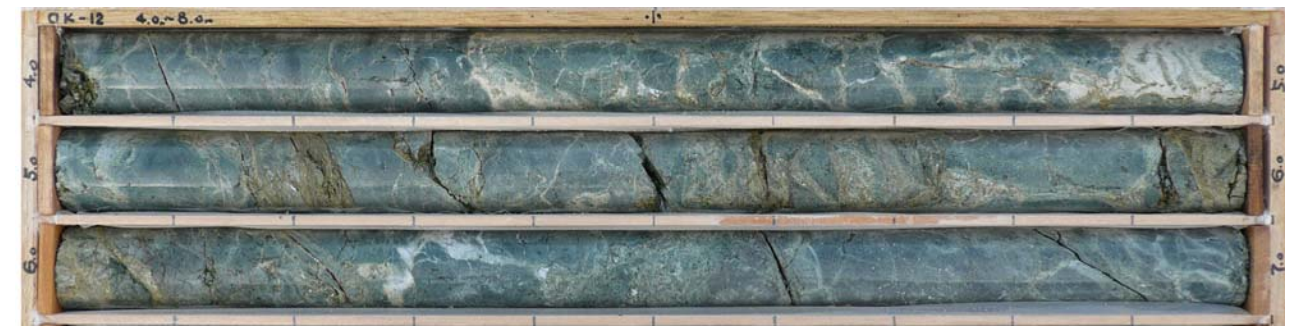
Ok-12ボーリング(孔口標高:EL.31.50m、掘進方向:289°、掘進角度:65°、掘進長:70m)
