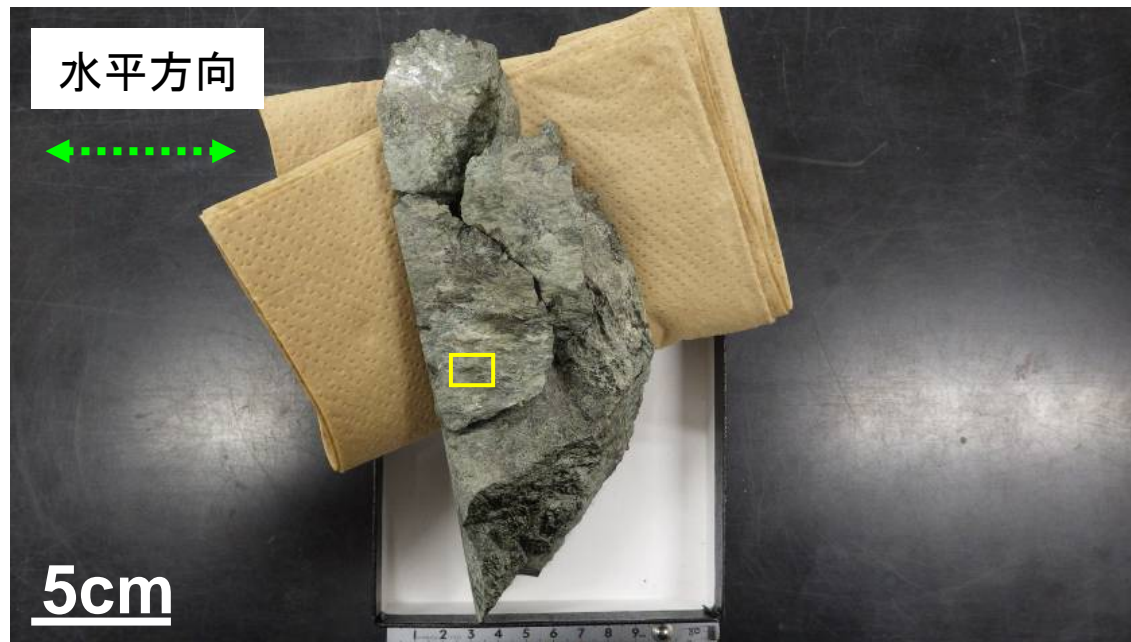
No. 35 69.5mの断層面(下盤上面)
