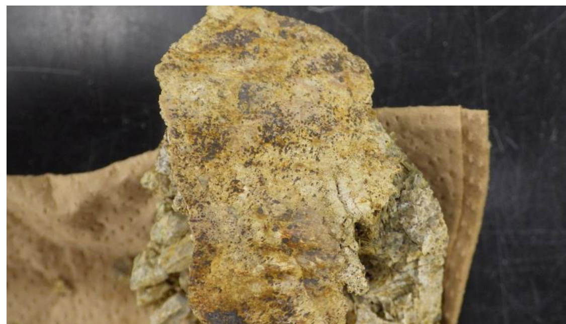
上盤下面の断層面の状況
