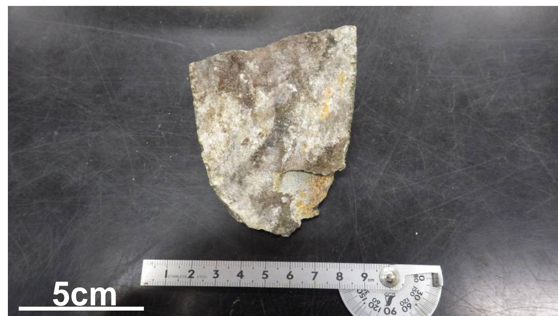
No. 8 149.30mの断層面(上盤下面)
