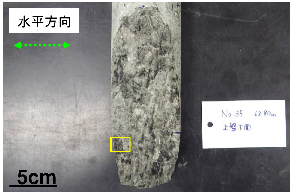
No. 35 63.80mの断層面(上盤下面)
