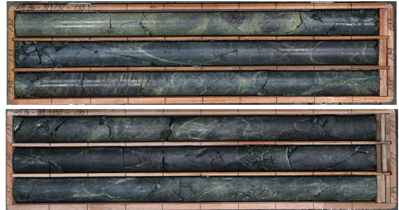
No.37ボーリング(孔口標高:EL.13.46m、掘進方向:49°、掘進角度:60°、掘進長:140m)
