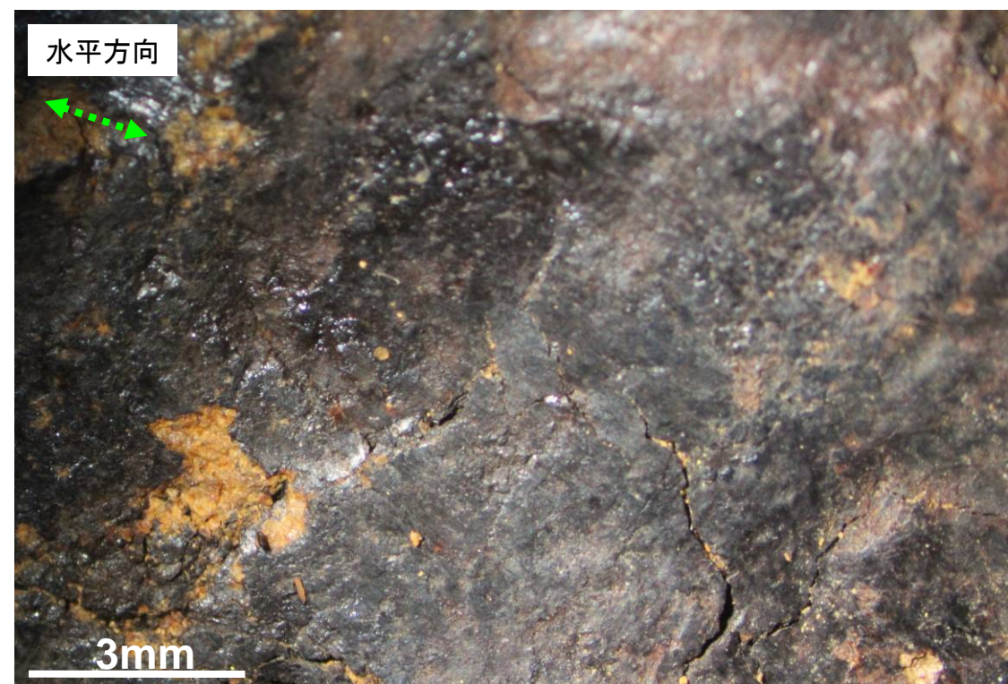
断層面の状況
