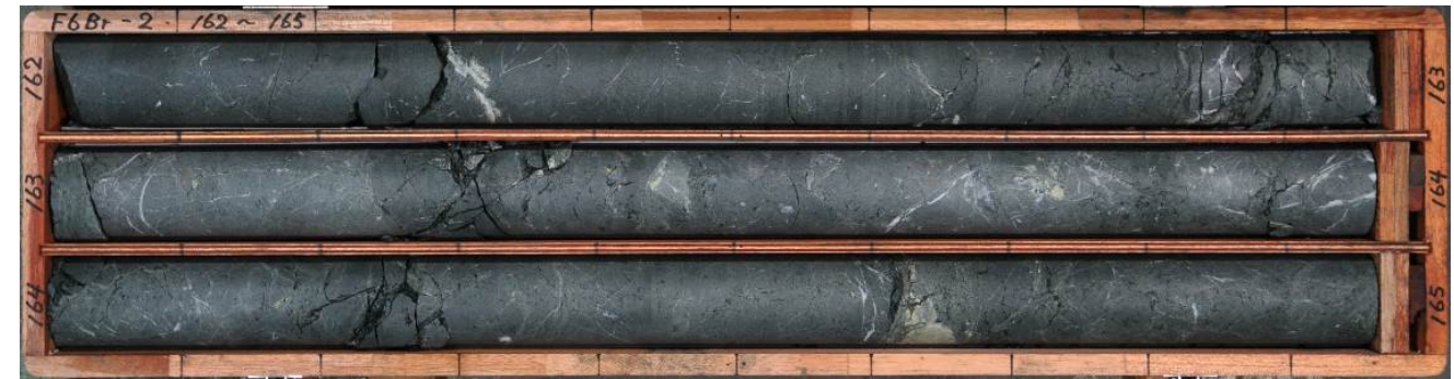
No.2ボーリング(孔口標高:EL.9.77m、掘進方向:88°、掘進角度:65°、掘進長:250m)
