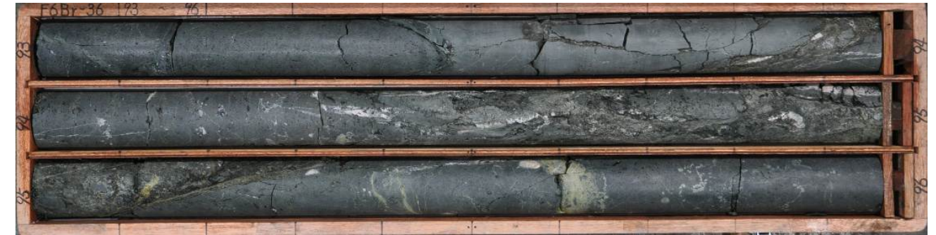
No.36ボーリング(孔口標高:EL.12.99m、掘進方向:229°、掘進角度:60°、掘進長:140m)
