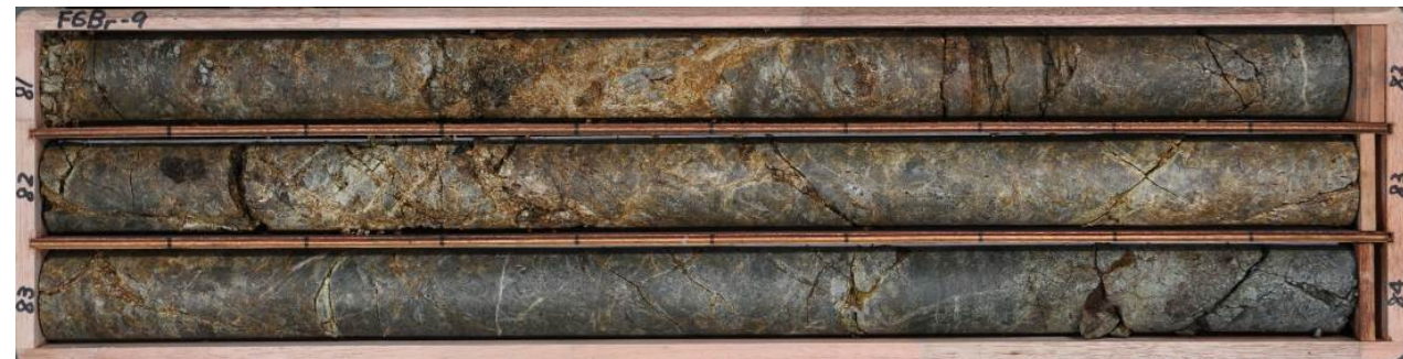
No.9ボーリング(孔口標高:EL.45.15m、掘進方向:82°、掘進角度:70°、掘進長:167m)
