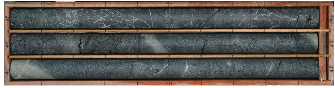
No.13ボーリング(孔口標高:EL.45.77m、掘進方向:93°、掘進角度:70°、掘進長:100m)
