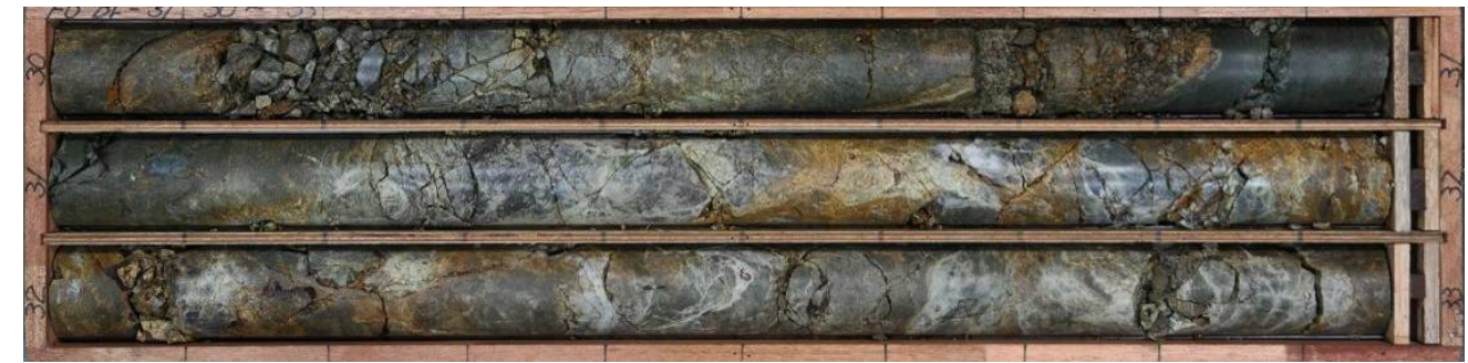
No.37ボーリング(孔口標高:EL.13.46m、掘進方向:49°、掘進角度:60°、掘進長:140m)
