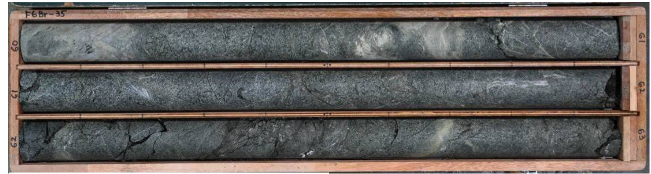
No.35ボーリング(孔口標高:EL.40.09m、掘進方向:93°、掘進角度 60°、掘進長120m)
