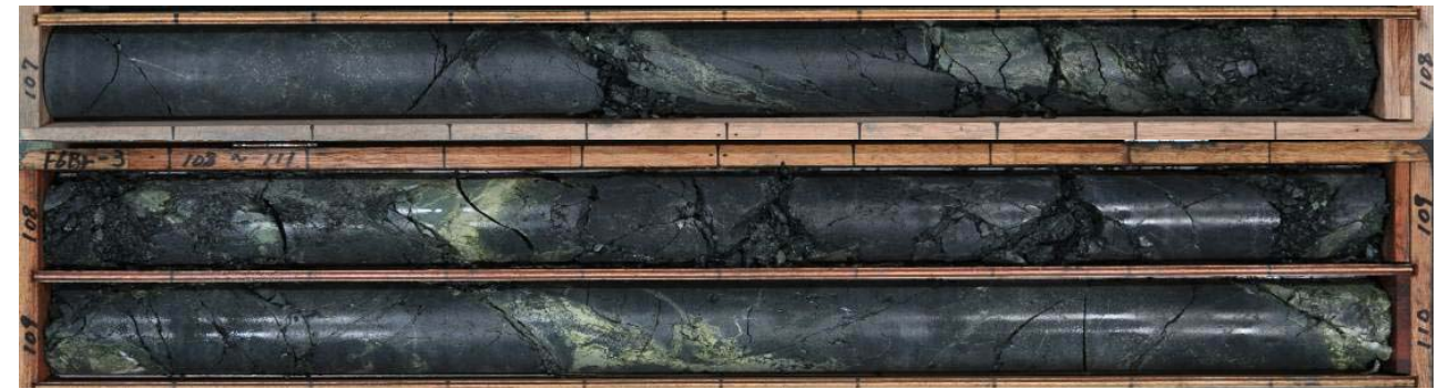
No.3ボーリング (孔口標高 EL.9.29m、掘進角度 70°、掘進長120m)
