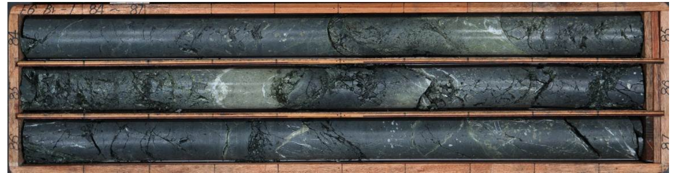
No.1ボーリング(孔口標高:EL.9.76m、掘進方向:49°、掘進角度:70°、掘進長:135m)
