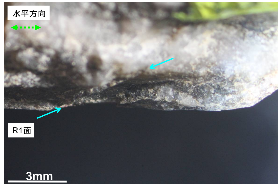
R1面(破断ステップの断面:左上写真の赤色矢印方向から撮影)
