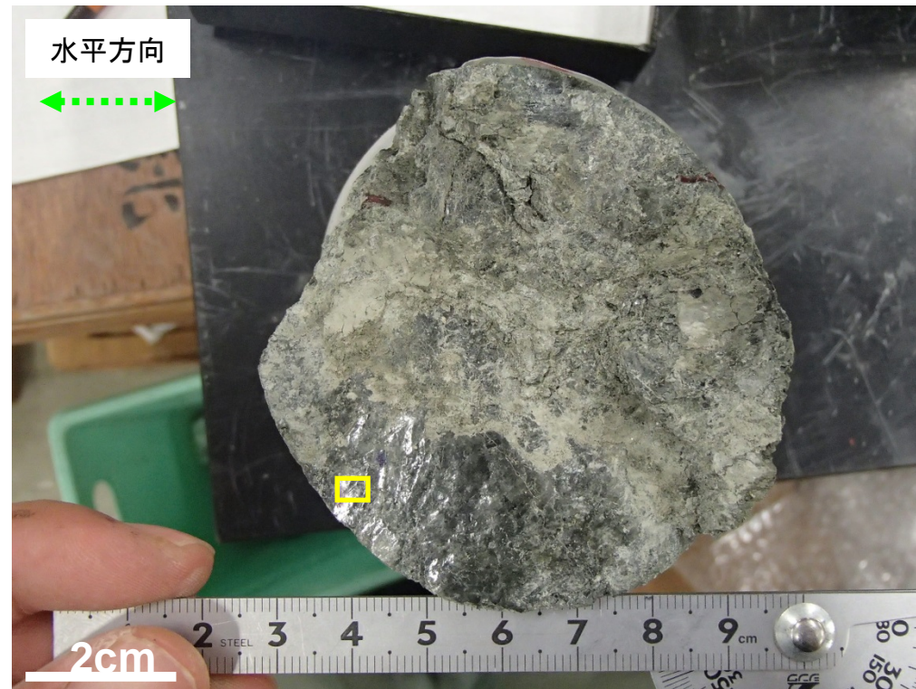
No. 13 76.48mの断層面(上盤下面)
