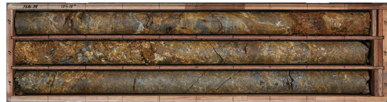
No.54ボーリング(孔口標高:EL.43.23m、掘進方向:75.6°、掘進角度:60°、掘進長:25m)
