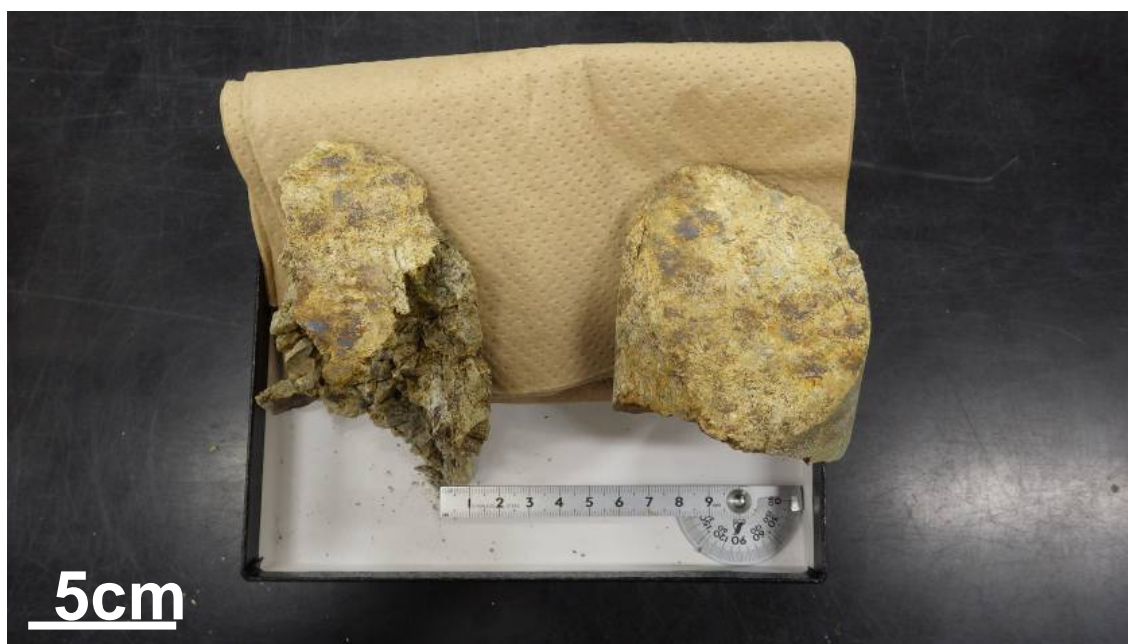
No. 9 150.50mの断層面(左は上盤下面、右は下盤上面)
