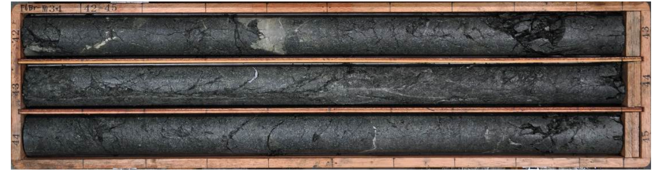
No.34ボーリング(孔口標高:EL.38.47m、掘進方向:273°、掘進角度:60°、掘進長:65m)
