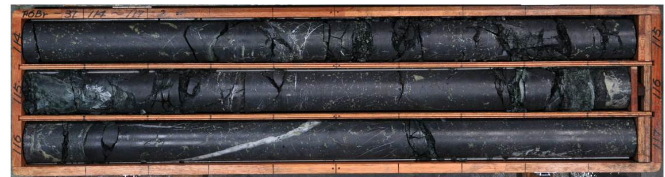
No.37ボーリング(孔口標高:EL.13.46m、掘進方向:49°、掘進角度:60°、掘進長:140m)
