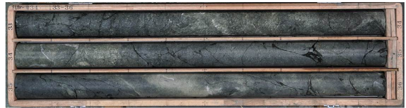
No.34ボーリング(孔口標高:EL.38.47m、掘進方向:273°、掘進角度:60°、掘進長:65m)
