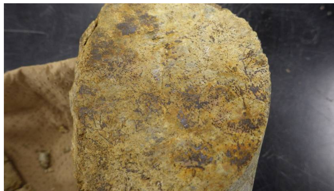
下盤上面の断層面の状況
