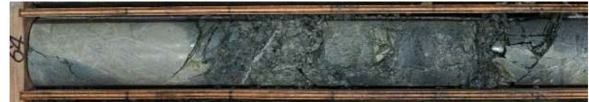
深度64.19~64.25m 輝緑岩中の幅5cmの角礫状破碎部(N69W/63S)。64.23mにコアでの傾斜35°、幅2mm程の灰白色の変質脈を挟在する。
