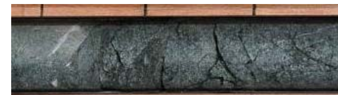
深度54.56~54.62m 輝緑岩中の幅7cmの礫混り角礫状破碎部(N18W/47W)。
