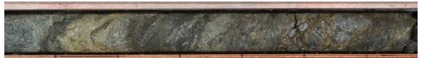
深度141.30～141.82m 細粒石英閃緑岩中の固結した角礫状破碎部(N46E/64NW)。傾斜45°、幅35cm程度。141.40mに傾斜60°、幅3mmの白色細粒部。141.45mに傾斜45°、幅1mmの灰色フィルム状細粒部挟在。
