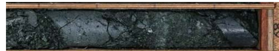
深度67.80~67.90m 輝緑岩中の角礫状破碎部(N68W/73S)。砂~細礫を主体とし、部分的に灰色の細粒分混じる。断層ガウジなし。
