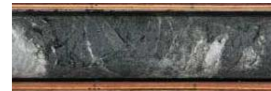
深度118.56～118.61m 輝緑岩中の幅5cmの角礫状破碎部 (N32E/51W)。
