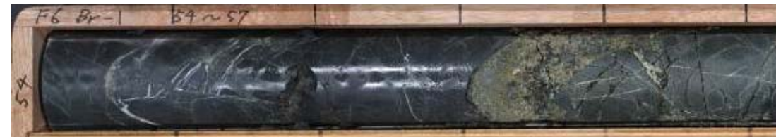
深度54.33~54.45m 輝緑岩中の幅5~7cmの固結した粘土混じり角礫状破碎部(N26E/71W)。上盤境界50°、下盤境界60°。断層ガウジなし。
