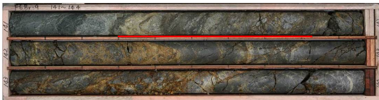
深度141.30～141.82m 細粒石英閃緑岩中の固結した角礫状破碎部(N46E/64NW)。傾斜45°、幅35cm程度。141.40mに傾斜60°、幅3mmの白色細粒部。141.45mに傾斜45°、幅1mmの灰色フィルム状細粒部挟在。
