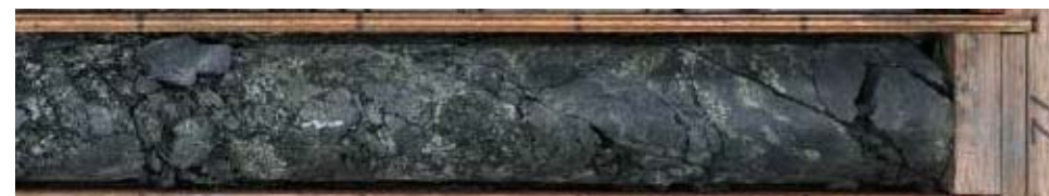
深度70.63~70.68m コアでの傾斜70°、輝緑岩中の幅7cmの砂混り角礫状破碎部(N87W/84S)。概ね固結。
