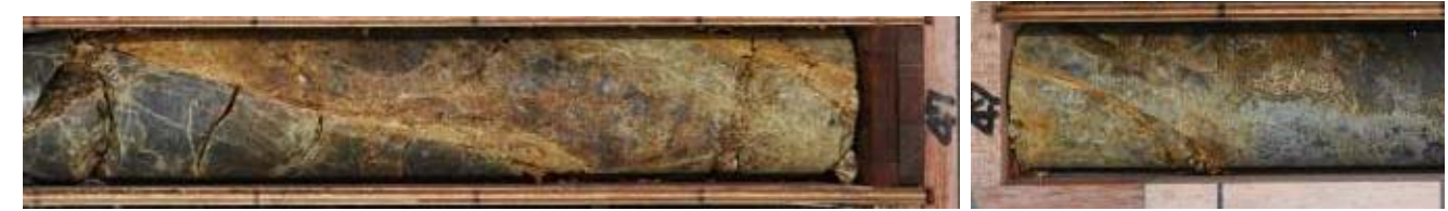
深度46.70～47.05m 細粒石英閃緑岩中の固結した角礫状破碎部(N2E/57E)。幅8cm、傾斜15～20°。連続性の悪い幅2mm以下の褐色細粒部挟在。
