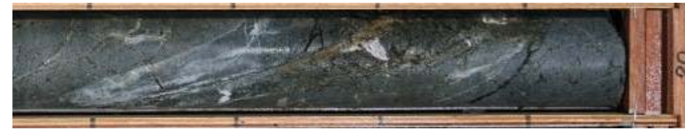
深度19.75m 輝緑岩中の幅2cmの角礫状破碎部(N75W/79SW)。
