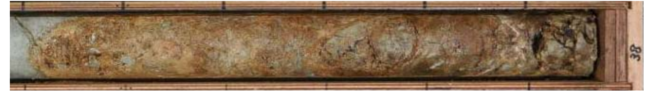
深度37.45~37.75m 細粒石英閃緑岩中の幅12cmの礫混り砂状破碎部 (N51E/63NW)。部分的に流入粘土は見られるが、断層ガウジは見られない。
