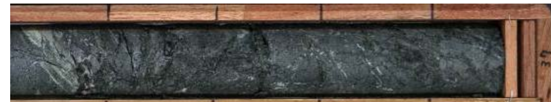
深度36.60~36.75m 輝緑岩中の幅15cmの砂状破碎部(N21W/31W)。
