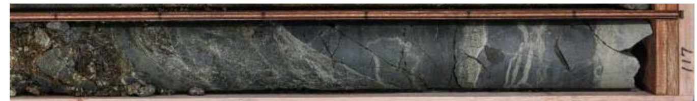
深度116.45～116.65m 細粒石英閃緑岩中の固結した角礫状破碎部(N27E/76W)。傾斜30°、幅14cm。下端に連続性の悪い幅5mm以下の灰色細粒部を挟在する。
