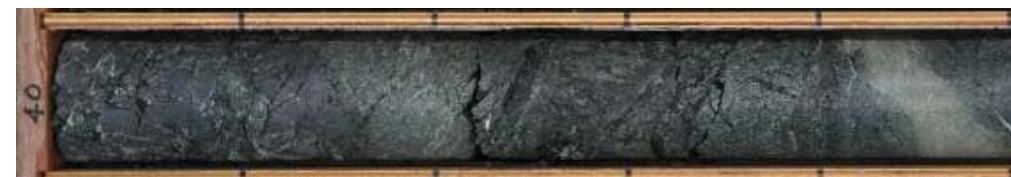
深度40.25~40.30m 輝緑岩中の幅6cmの角礫状破碎部(N11W/62W)。
