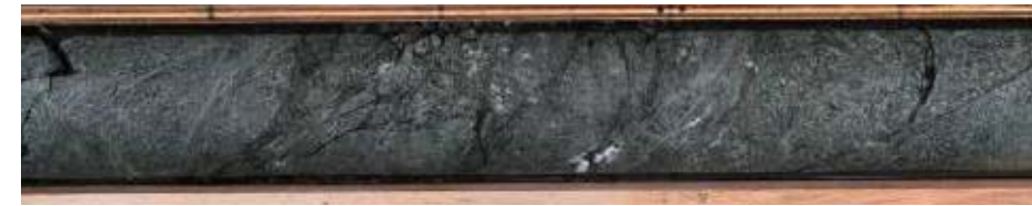
深度62.33～62.53m 輝緑岩中の幅18cm、傾斜45° の固結した角礫状破碎部 (N48W/57SW)。上端に幅1cm、下端に幅2cmの礫混り砂状破碎部を伴う。
