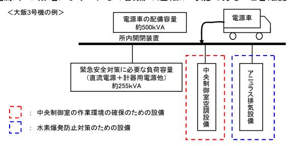
換気空調設備(中央制御室空調設備およびアニュラス排気設備他)の起動に必要な容量
