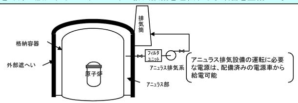
アイスコンデンサ型格納容器のPWRプラントに対し、電源車からの給電によるイグナイタを運転する手順書を整備した。
