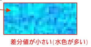
腐食の進行具合が異なる電線の差分値画像とその腐食具合を蓄積。その画像と評価したい電線の差分値画像を比較することで、腐食の進行具合を判定する
