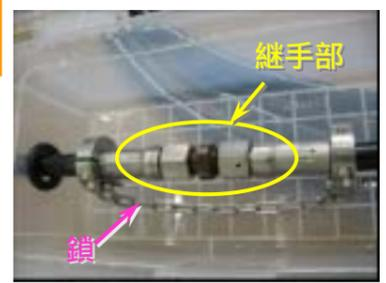
高圧ホース継手部の外れ防止として、鎖で固定
