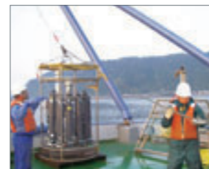
海底感知センサー付き多項目観測・採水システムにより底上水を正確に採水
