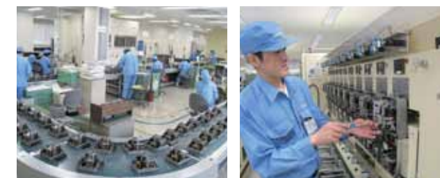
回収した電力メーターは整備して再生
