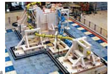
振動台での主蒸気配管試験
