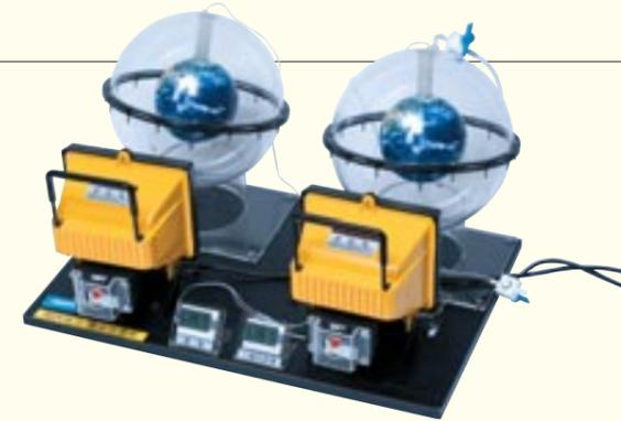
地球儀を囲む容器は一方に空気を、もう一方にCO<sub>2</sub>を封入。ハロゲンライトで加熱して温度をチェックし、上昇率の違いを確認する実験で、地球温暖化のイメージを子どもたちにわかりやすく伝える
