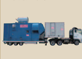
空冷式非常用発電装置の設置
