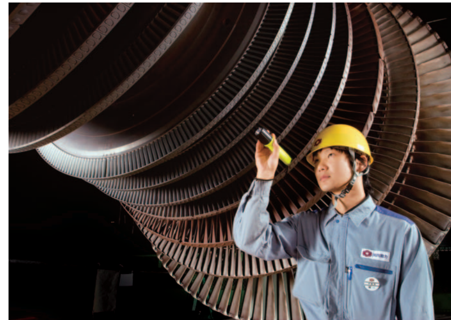
発電所のタービン点検作業
