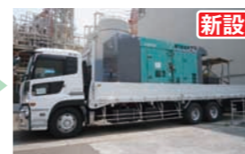
【電源車(5台/2ユニット)】
