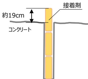
接着剤を3本挿入するとコンクリートに空けた穴から約19cm出るため、2本の接着剤を挿入し、ハンマードリルで攪拌を行った後、3本目を挿入するために回転が停止した後に鉄筋を引き抜く作業が必要であった。
