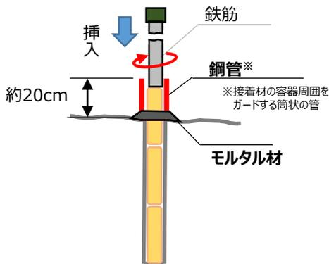
鋼管を設置することにより接着剤を3本一度に挿入・攪拌ができることから、手作業で引き抜く作業を不要とした。
