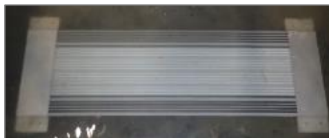
熱回収管の浸漬サンプル (幅600mm、長さ2,000mm、高さ24.5mm)
