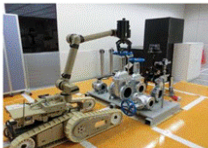
バルブの開閉操作
