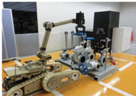
バルブの開閉操作
