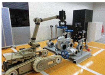
バルブの開閉操作
