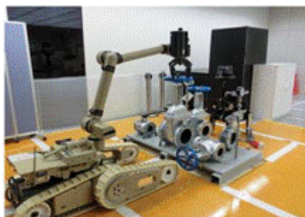
バルブの開閉操作
