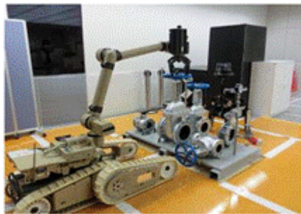
バルブの開閉操作
