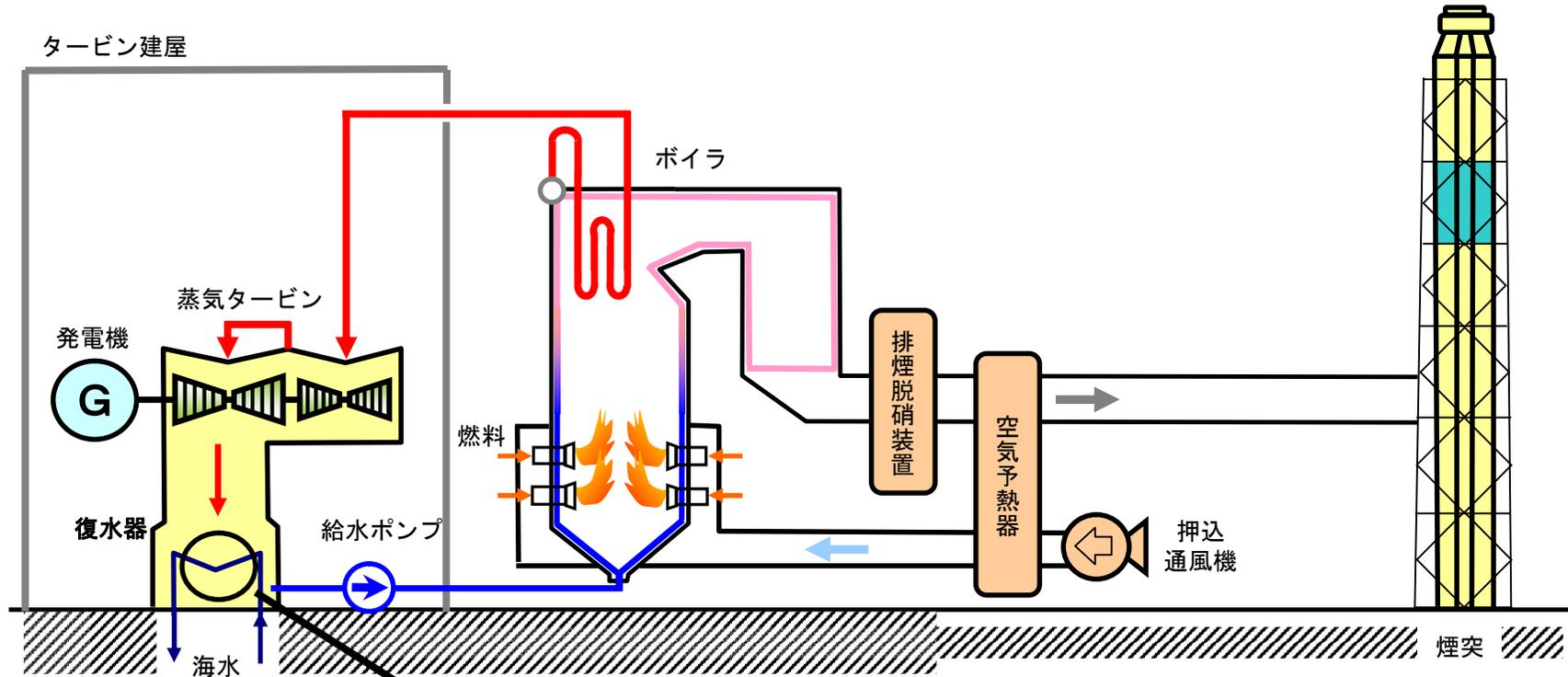
細管内面への海洋生物の付着により、局所的に海水の流速が増加した結果、細管の減肉が進行して微細な穴が発生したものと推定。
