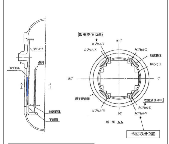
カプセル : 照射試験片を収納した箱型の容器
