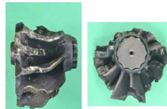
排気出口 全てのタービン翼が破損
