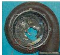
タービンバックプレートが破損
