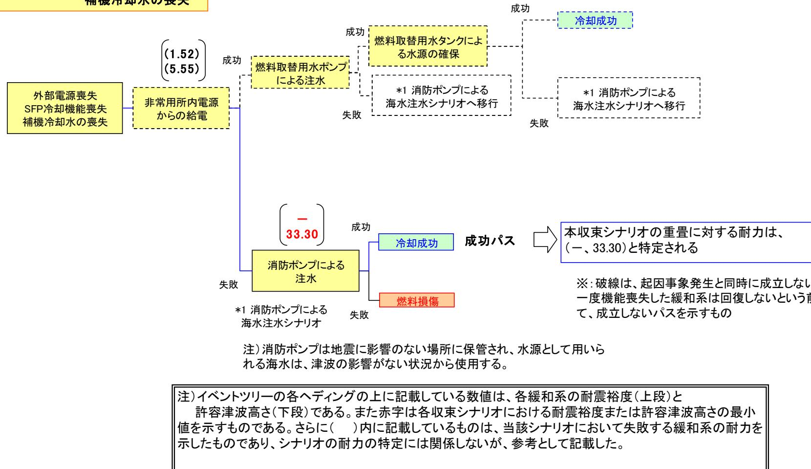
各シナリオの重畠に対する耐力の評価結果（重畠：SFP（地震による起因事象をベースとした評価））
