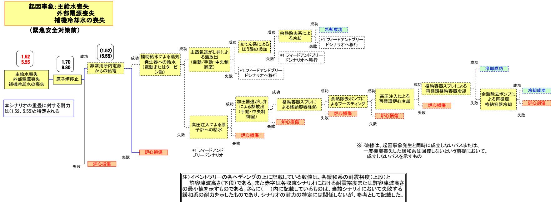
各シナリオの重畠に対する耐力の評価結果（重畠：炉心損傷（地震による起因事象をベースとした評価））
