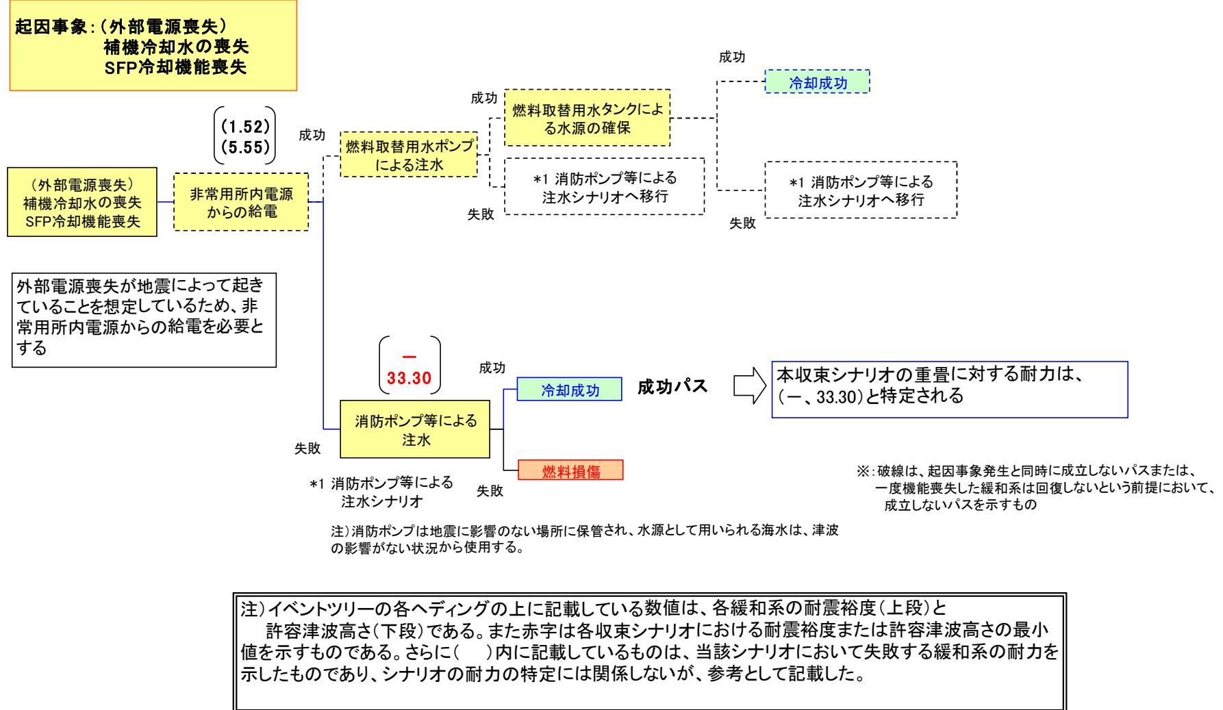
各シナリオの重畠に対する耐力の評価結果（重畠：SFP（津波による起因事象をベースとした評価））
