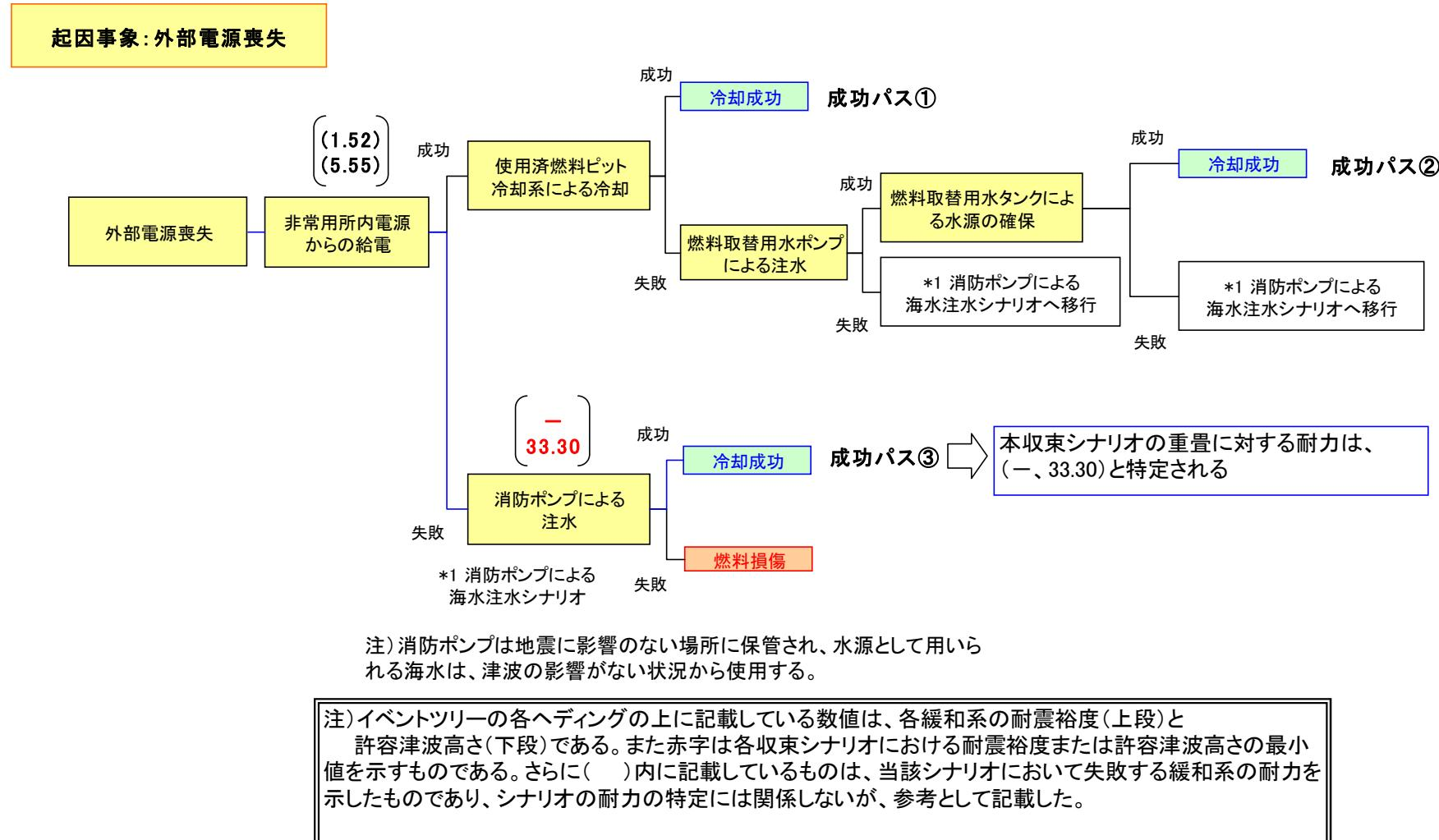
各シナリオの重畳に対する耐力の評価結果（重畳：SFP（地震による起因事象をベースとした評価））
