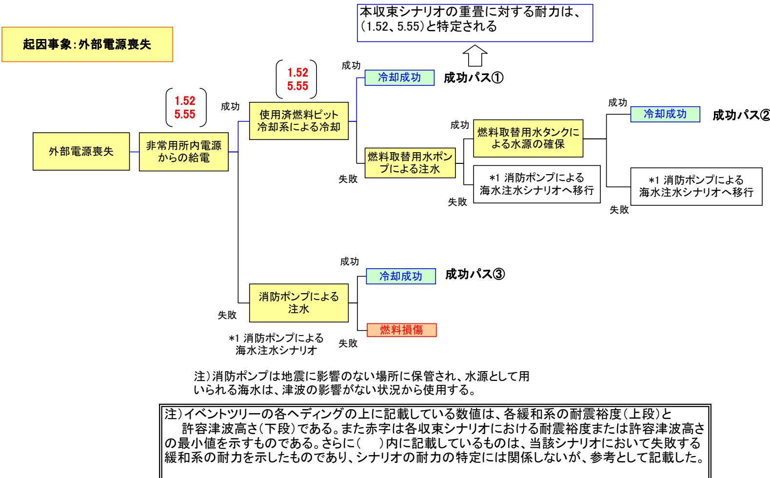
各シナリオの重畠に対する耐力の評価結果（重畠：SFP（地震による起因事象をベースとした評価））
