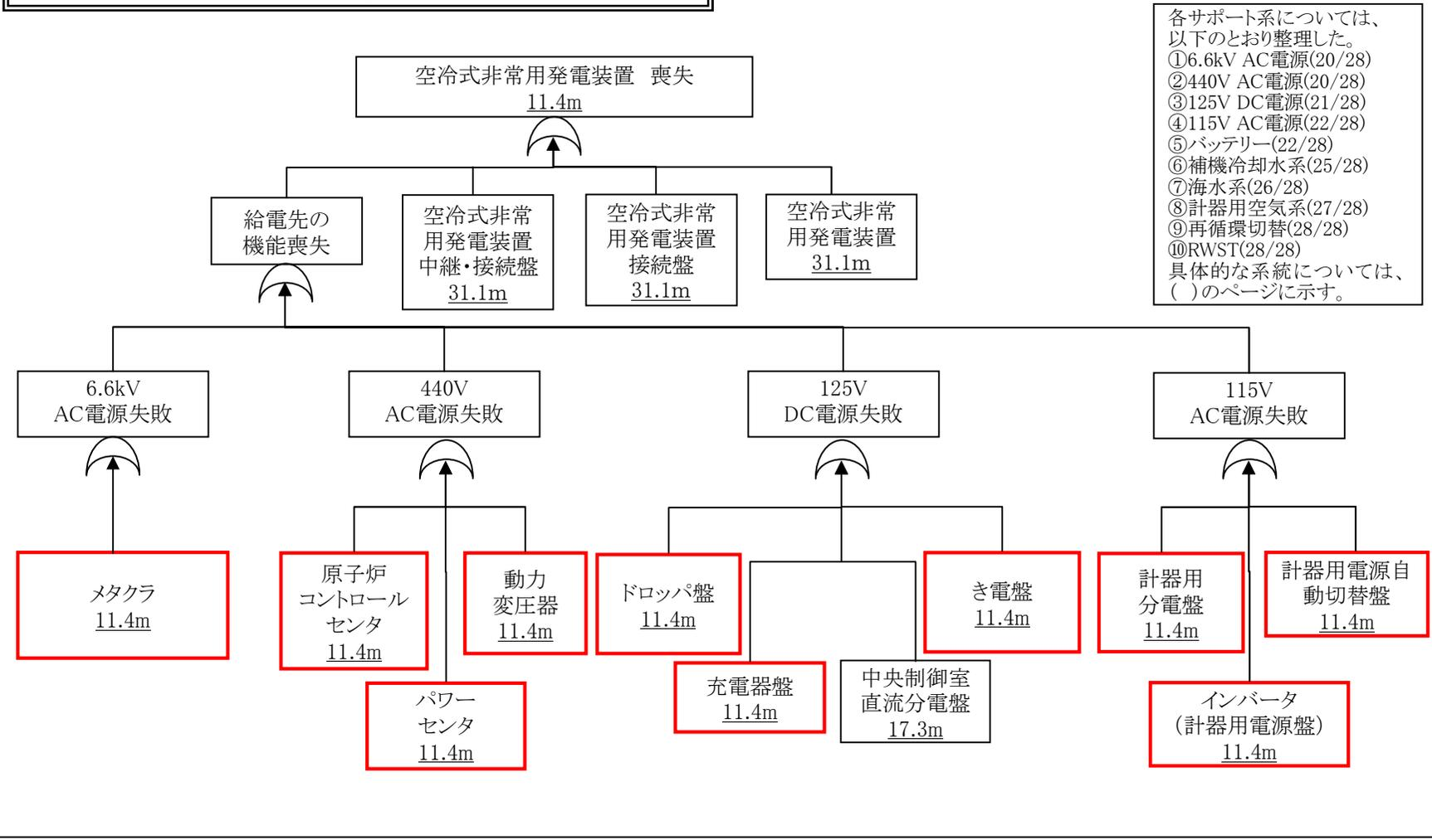
各影響緩和機能のフォールトツリ- (津波: 炉心損傷)
