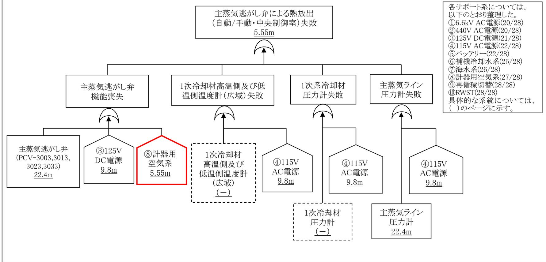
各影響緩和機能のフォールトツリー(津波:炉心損傷)
