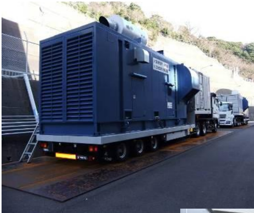
空冷式非常用発電装置
