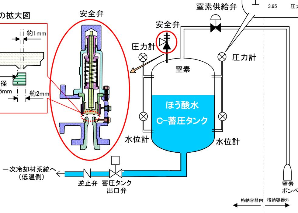
大飯発電所1号機 C-蓄圧タンク圧力低下の点検結果(2/3)
