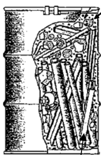
切断処理した固体状廃棄物
