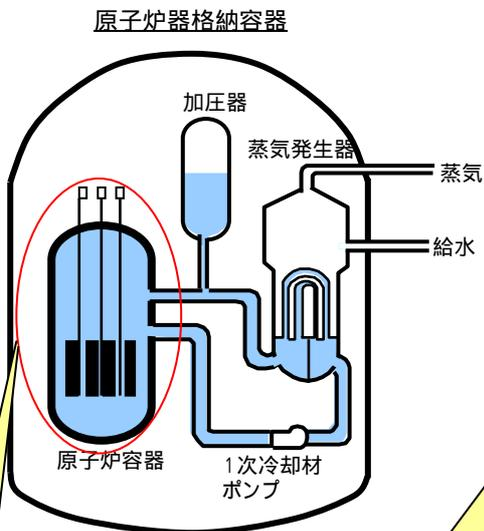
原子炉容器概略断面図
