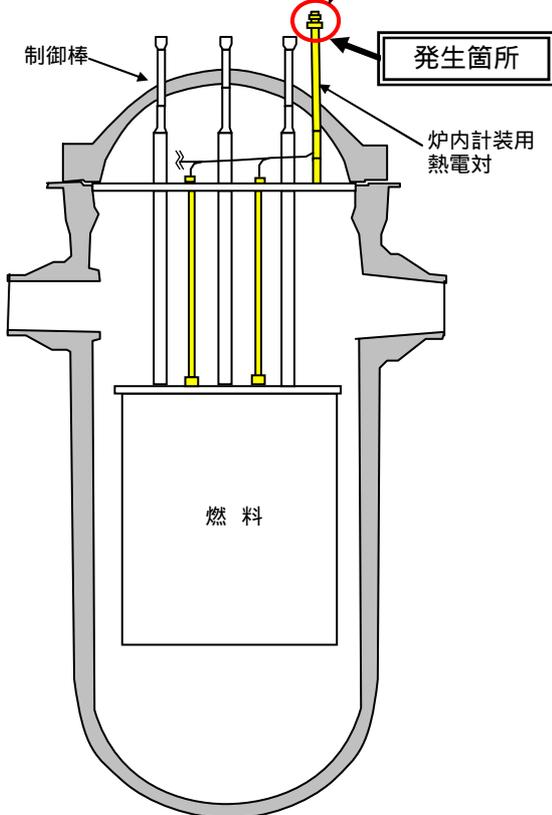
炉内計装用熱電対の写真
