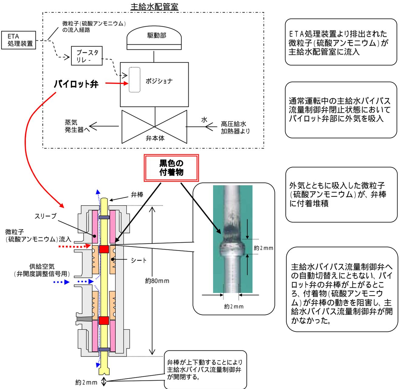
微粒子(硫酸アンモニウム)の流入経路
