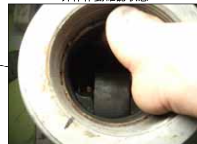
弁体作動確認状態
