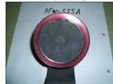
弁体当り確認状態
