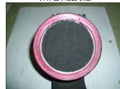
弁体当り確認状態
