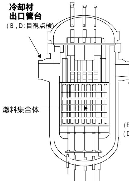
原子炉容器冷却材出入口管台の点検概要
