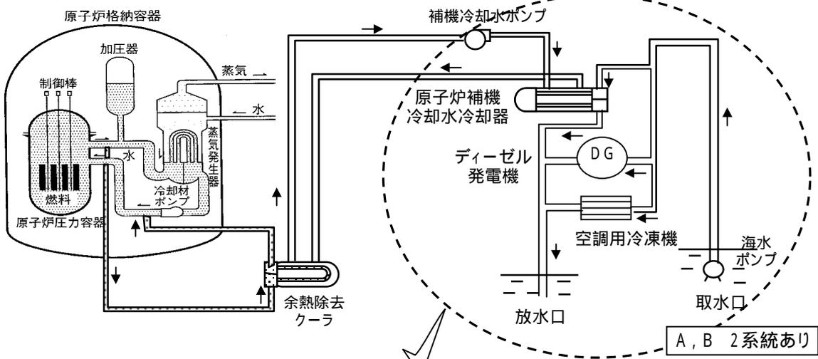
原子炉補機冷却系統概略図
